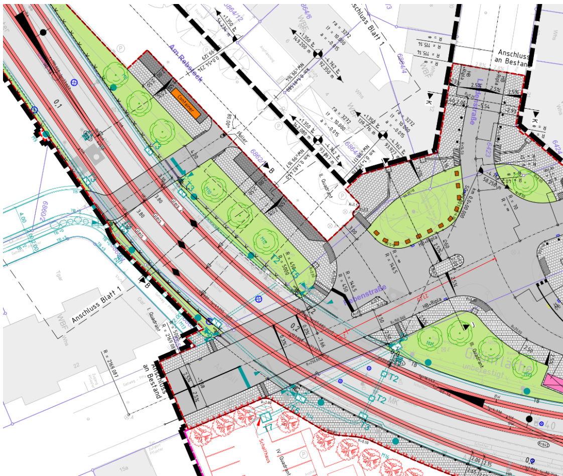
Abbildung 6: Abgesetzte Radquerung für den Radschnellweg (Antragsvariante)
