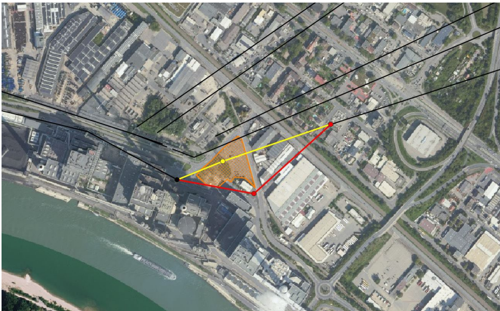
Abbildung 2: Gegenwärtiger und zukünftiger Leitungsverlauf: Schwarz=Bestand, rot=Neubau, gelb=Rückbau, orange=geplantes Umspannwerk. Quelle Luftbild: © GeoBasis-DE / BKG 2022
