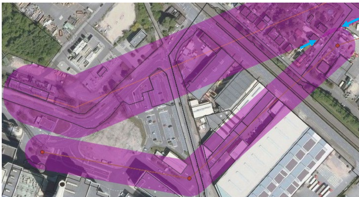
Abb. 5: Nach Kapitel II.3.1 der LAI-Hinweisen auf maßgebliche Immissionsorte hin zu überprüfender Bereich der 110-kV- und der 220-kV-Freileitungen, der Überschneidungsbereich ist mit hellblauen Pfeilen markiert
