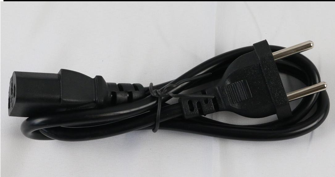
Gefährliches Anschlusskabel - dreipoliger Kaltgerätestecker auf zweipoligem EURO-Stecker
