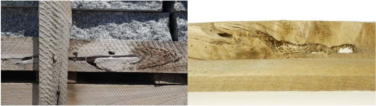
Abbildungen 4 und 5: Larvengänge in dem Verpackungsholz einer Steinladung; rechts mit Genagsel und Spänen (Bilder von Wuthenau)
