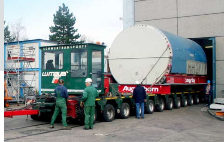
Abtransport des Generators
