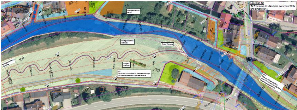
Abbildung 26: Maßnahme N2 – Einlaufbereich der Flutmulde mit Niedrigwasserrinne
