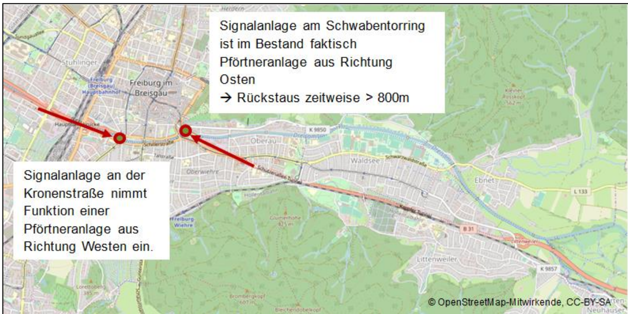
Abbildung 7.4-1: Pförtneranlagen im Bestand [16].
