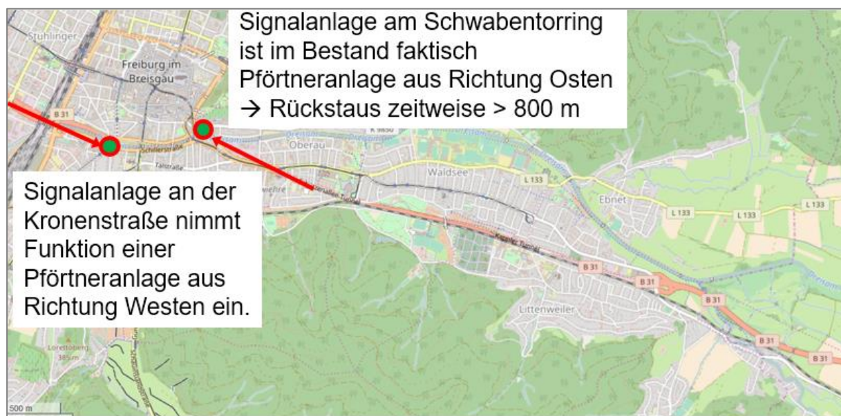
Abb. 4-1: Pfortneranlagen im Bestand.
