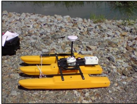
Abb. 5: Trimaranschwimmkörper mit ADCP und GPS
