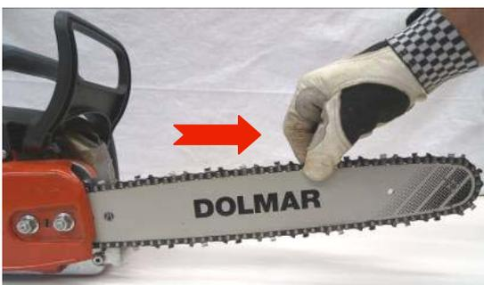
5. Die Kette soll sich mit zwei Finger über die Führungsschiene ziehen lassen!
