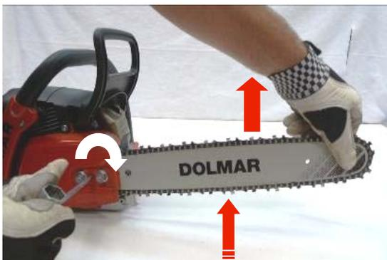
3. Kette spannen bis diese an der Schienenunterseite komplett anliegt
