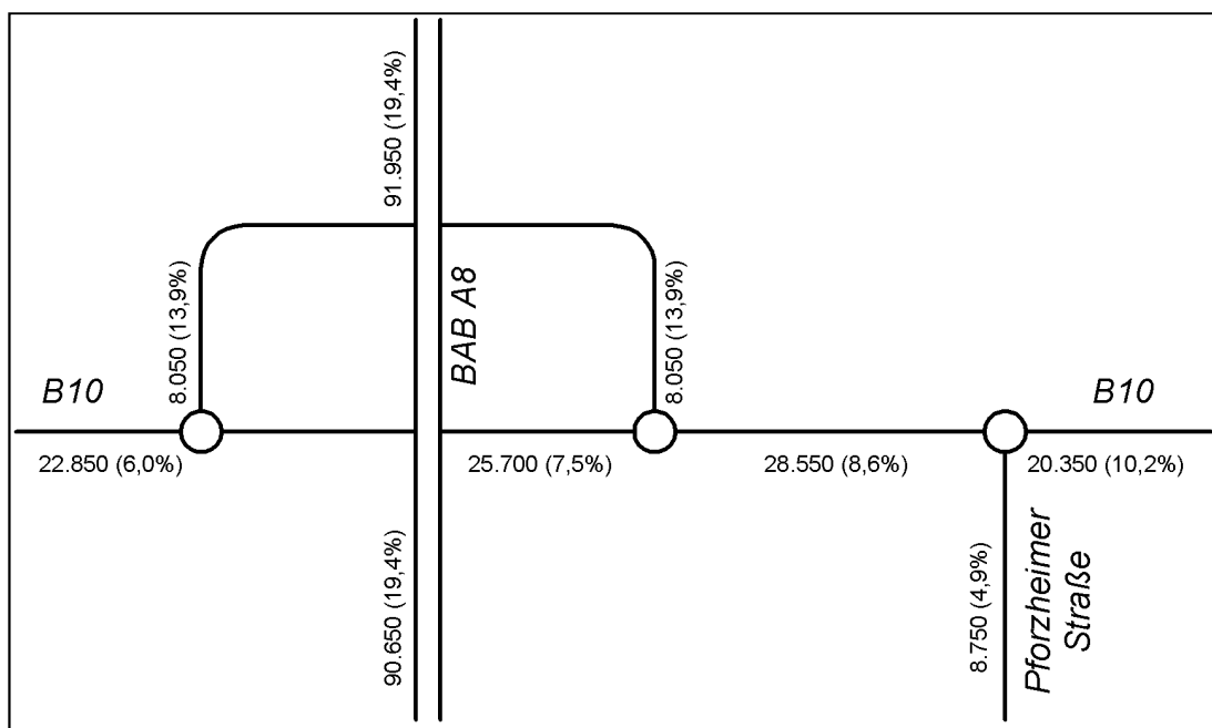
Abb. 1: Verkehrserhebungen aus dem Jahre 2016 in Kfz/24 h, in Klammern: Schwerverkehrsanteil >3,5 t in %
