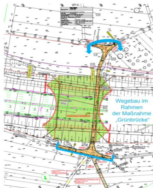
Abb. 13: Abgrenzung zwischen den Wegebau-Maßnahmen der Flurneordnung und dem Wegebau im Rahmen der Grünbrücke, siehe auch verbale Ausführungen im Kapitel 4.5 „Knotenpunkte und Weganschlüsse“
