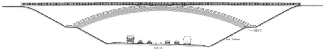
Abb. 9: Ansicht der Brücke Variante 3, Überspannung der BAB A8 mittels Bogentragwerk
