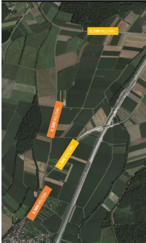
Abbildung 4: Verkehrszahlen DTV gemäß Verkehrsmonitoring 2019
