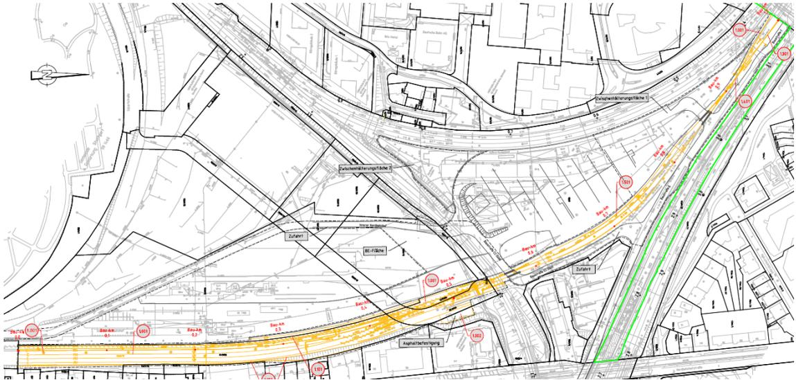
Abbildung 4: Lage Rückbau Logistikgleise (orangefarben) (aus: Lageplan Rückbau Gleisvorfeld Stuttgart Hbf, Bereich Logistikfläche, Rückbau der Logistikgleise, Stand: 16.05.2019)
