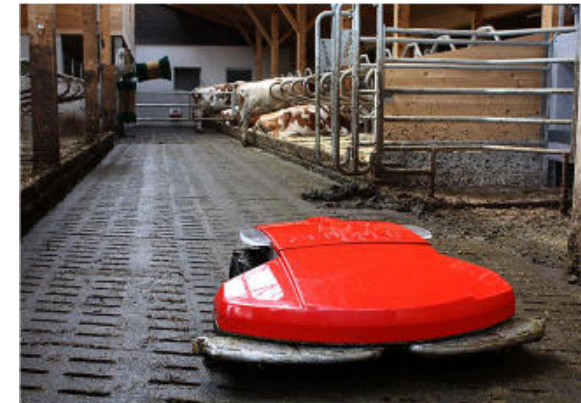
Abbildung 3: Spaltenroboter , Quelle: https://www.schauer-agrotronic.com/rinderstall/guelle-u-entmistungssysteme/entmistungsroboter/ , abgerufen am 12.10.2018
