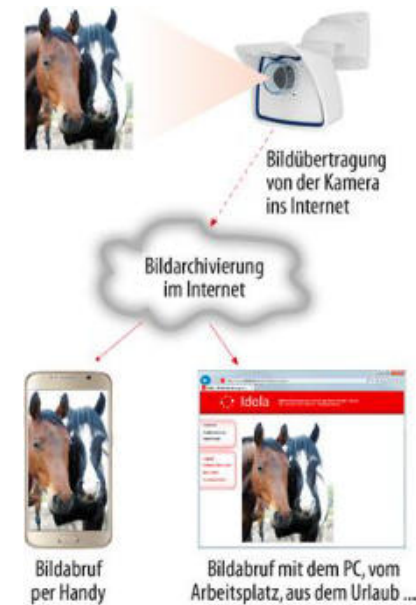
Abbildung 2: Funktionsweise der Stallkamera, Quelle: http://www.stallkamera.de/technik/index.php , abgerufen am 17.08.2018
