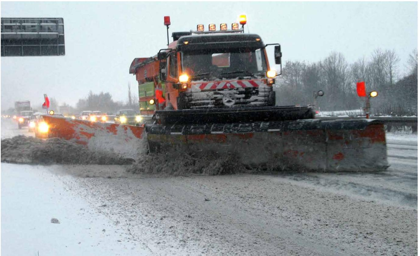
*Wegen einer maximalen Gesamträumbreite von ca. 7 Metern wird auf Autobahn am Räumgerät ein Seitenflug eingesetzt*
