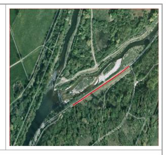
**Maßnahme**: Der bestehende Damm wird auf einer Länge von 160 m um einen Betrag von 0,45 m bis 1,00 m abgesenkt und überströmungssicher hersgestellt. Die Dammkrone wird asphaltiert und die luftseitige Böschung mit einem massiven Steinwurf gesichert
