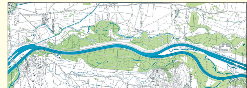
Topographische Karte von 1963. Der Oberrheinausbau wurde bis Breisach als Rheinseitenkanal, ab da in Form der sogenannten „Schlingenlösung“ ausgeführt. Für die hier dargestellte Staustufe Marckolsheim wurde zur Ausleitung in die Kanalschlinge bei Burkheim ein Wehr errichtet und die Dämme entlang der Stauhaltung bis unmittelbar an das Flussbett herangezogen. Der Rheinwald zwischen Breisach und Burkheim wird von keinem Hochwasser mehr erreicht.
