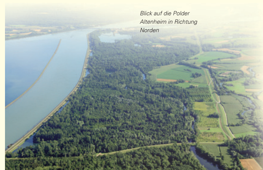
Um den gleichen Hochwasserschutz herzustellen, wie er vor dem Oberrheinausbau vorhanden war, müssen die 200-jährlichen Hochwasserspitzen am Pegel Maxau um 700 m³/s durch Rückhaltmaßnahmen abgemindert werden.
