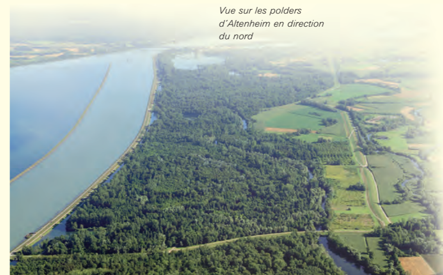
Si l'on veut rétablir la même protection contre les crues qu'avant l'aménagement du Rhin supérieur (jusqu'en 1977), les pointes des crues bi-centennales à la station de Maxau doivent être écêtées de 700m³/s par la mise en œuvre de mesures de rétention.
