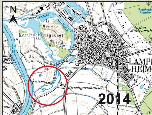
Mit der Dammrückverlegung Kirschgartshausen wurde zwischen Mannheim und Lampertheim eine alte Flutrinne des Rheins wieder aktiviert und mit dem Lampertheimer Altrhein verbunden. Bei Hochwasserereignissen wird die reaktivierte Aue überflutet. Durch die wechselnden Wasserstände wird sich, wie im Lampertheimer Altrhein, eine naturnahe Auenlandschaft mit einer artenreichen Tier- und Pflanzenwelt entwickeln.
