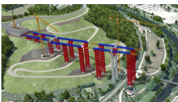
Visualisierung Bauablauf Neckartalbrücke Horb
