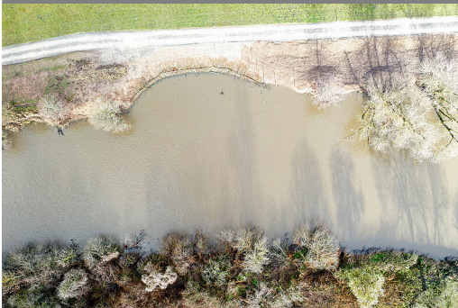
Spreitlagen bei Hochwasser von oben
