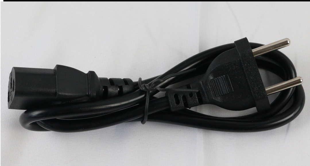
Gefährliches Anschlusskabel - dreipoliger Kaltgerätestecker auf zweipoligem EURO-Stecker
