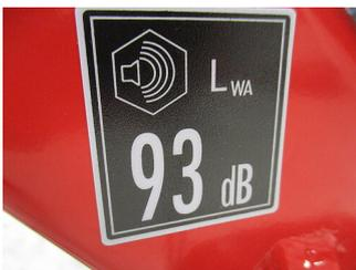
ABBILDUNG : Angabe des Schallleistungspegel / Quelle: RPT
