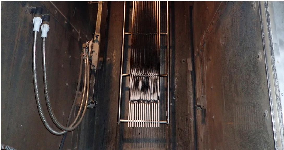
Messung der Wärmefreisetzung und Raucherzeugung von Kabeln nach EN 50399 - nach dem Versuch
