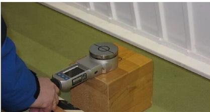
Messung der Schließkräfte an einem Garagentor
