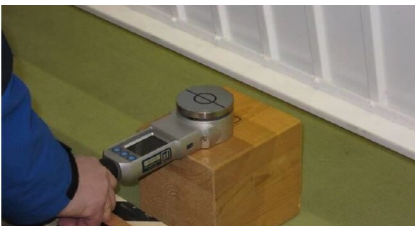
Messung der Schließkräfte an einem Garagentor
