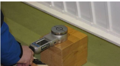
Messung der Schließkräfte an einem Garagentor
