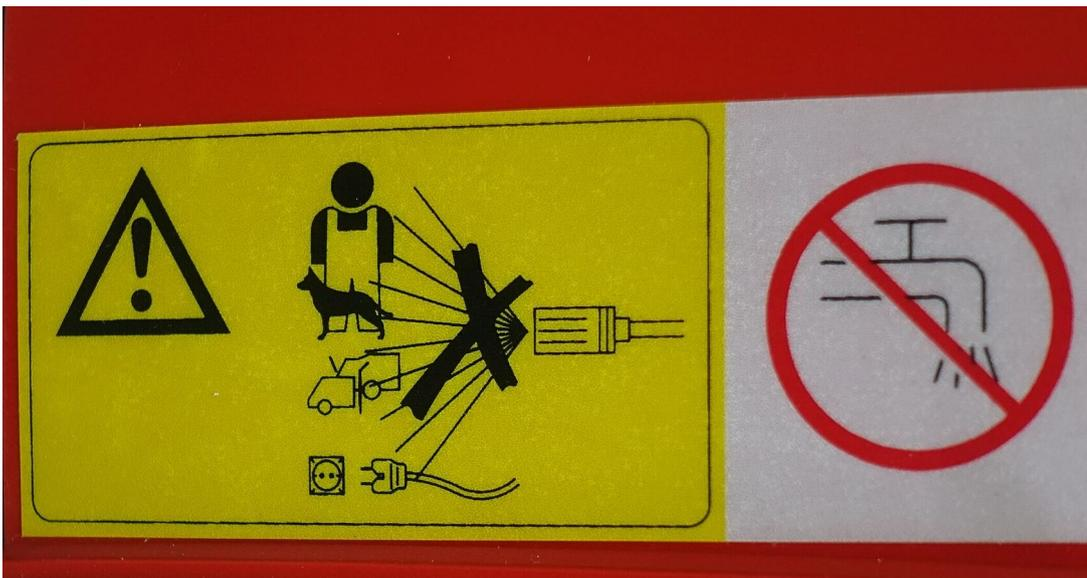
Warnschild - Hochdruckreinigungsgeräte dürfen nicht direkt an die Trinkwasserversorgung angeschlossen werden
