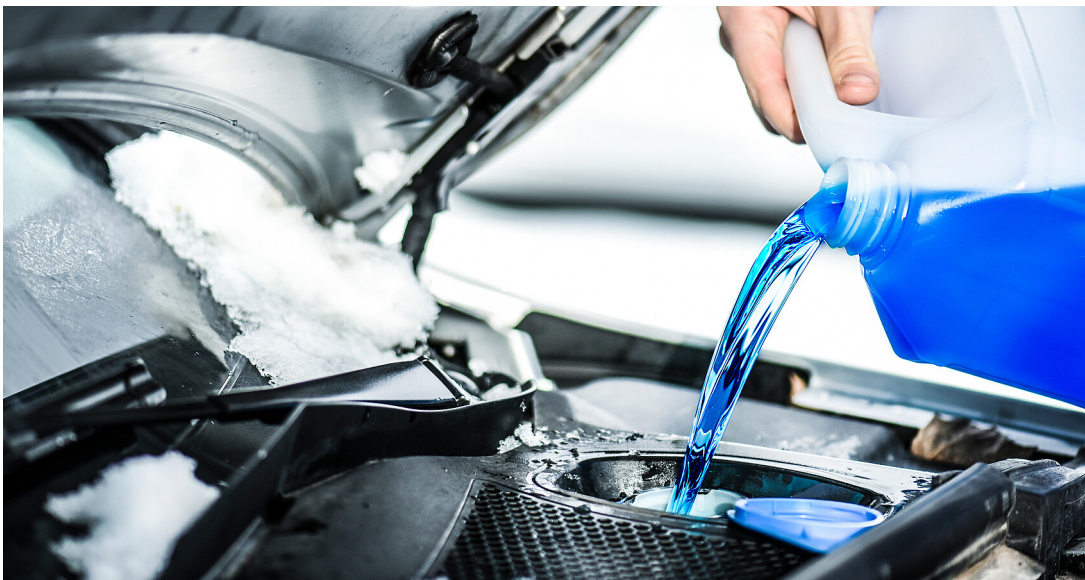
Befüllen eines Fahrzeuges mit Scheibenwischflüssigkeit beziehungsweise Scheibenfrostschutzmittel
