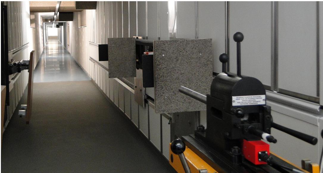
Geschossgeschwindigkeitsmessanlage im Schießkanal B100
