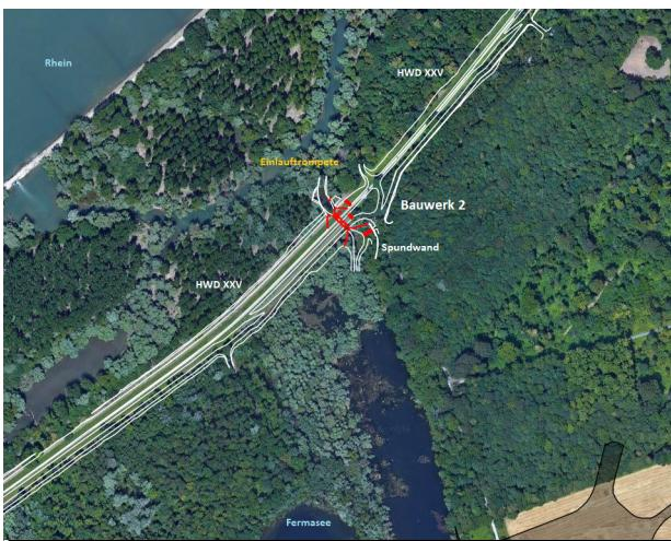
Das Bauwerk 2 liegt im Hochwasserdamm XXV an der Stelle der abzubrechenden, bisherigen Bellenkopfschließe, die den Fermasee mit dem Altrhein im Rheinvorland verbindet.
