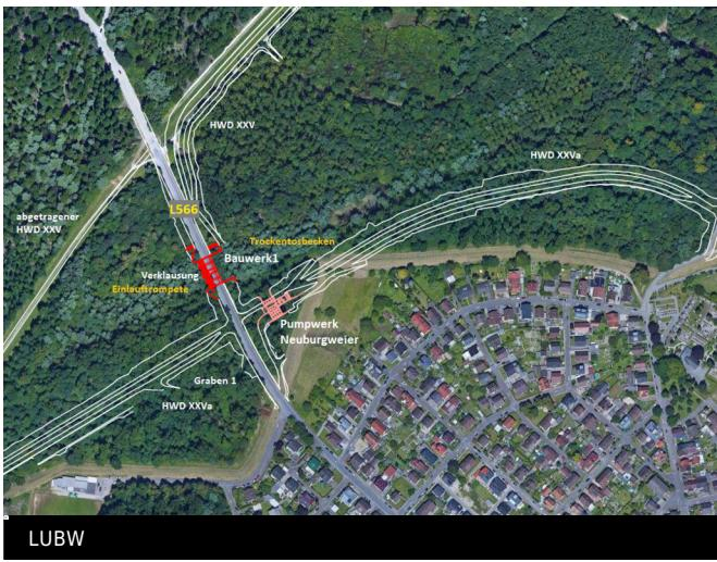
Das Bauwerk 1 liegt im neuen Dammübergangsstück zwischen dem Hochwasserdamm XXV und dem neuen Hochwasserdamm XXVa. Dieses Bauwerk wird ausschließlich zum Einlass von Rheinwasser genutzt.
