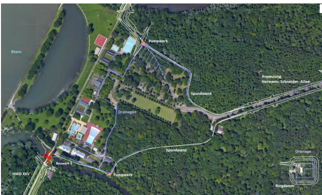
Umschließung und Grundwasserhaltung Rheinpark
