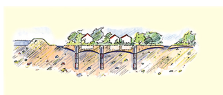
Grundwasserhaltung mit Brunnen
