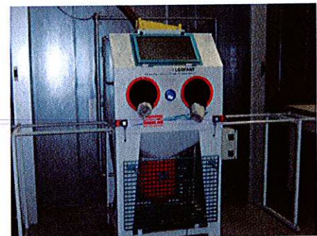
Die neuinstallierte Strahlkabine zur Reinigung des Metallblocks.
