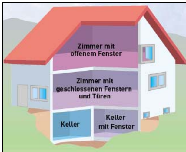
Im Haus bieten Kellerräume ohne Fenster den besten Schutz.
