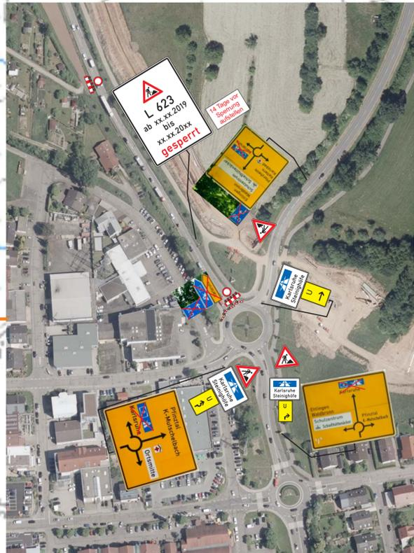
Der Verkehrssicherung widersprechende Beschilderung ist mit geeigneten Mitteln abzudecken bzw. mit berührungsfreier Auskreuzvorrichtung auszukreuzen
