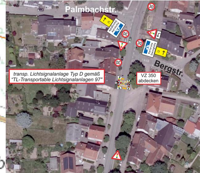
transp. Lichtsignalanlage Typ D gemäß "TL-Transportable Lichtsignalanlagen 97"
