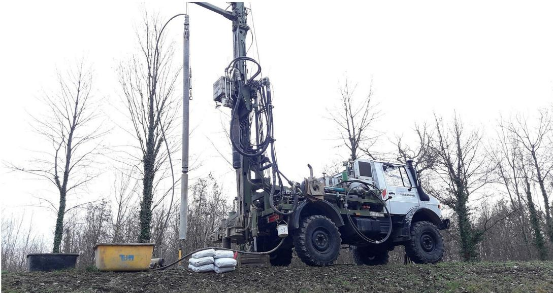
Rammkernbohrgerät auf dem RHWD XXIII
